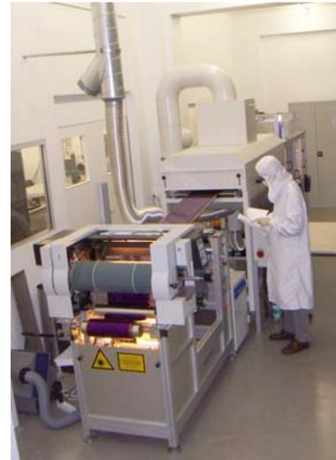
3<sup>ème</sup> machine de mise en série, enfin « roll-to-roll »
